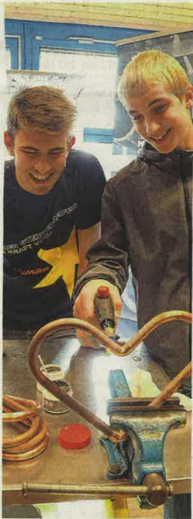
Der Auszubildende Niklas Lorenz (links) zeigt Tobias Kaufmann wie man Kupferrohre lötet.
